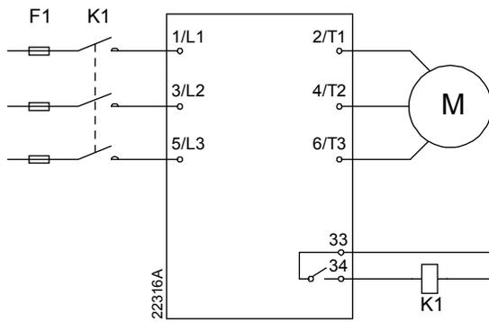
*Arrancador suave instalado con un relé de derivación e interruptor automático*
